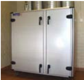
Luftbehandlingsaggregat Welair, av typ Matrix-350 med alla kanalanslutningar uppåt. Roterande värmeväxlare, inbyggd värmebatteri och frekvensstyrda kammarfläktar
